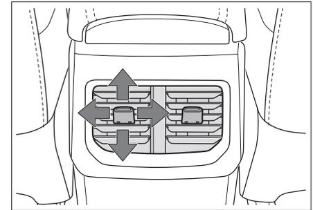
Перемещая рычажки дефлекторов, можно регулировать направление воздушного потока.
