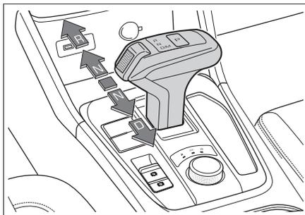
Быстро переместите селектор переключения передач в нужное положение. При необходимости преодолите точку сопротивления. Отпустите селектор, и он автоматически вернется в промежуточное положение.
