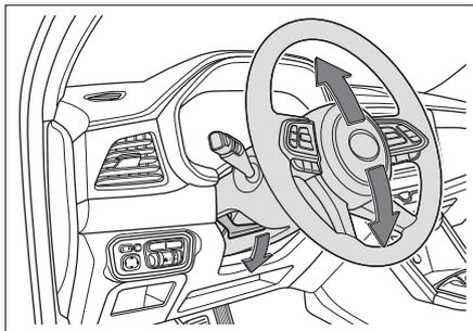
1. Опустите регулировочный рычаг, расположенный под рулевым колесом.
