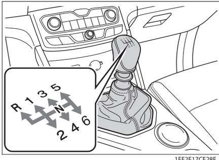
Коробка передач имеет заднюю передачу (R), нейтральную передачу (N) и шесть передач для движения вперед.
