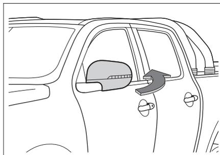
Чтобы сложить боковое зеркало, потяните его по направлению стрелки, держа за корпус. Перед началом движения следует вернуть зеркала в исходное положение.
