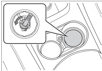
4. Поднимите тросик, поднимите ручку в верхнее положение и поворачивайте ее по часовой стрелке, пока не услышите негромкий звук. Он будет означать, что рукоятка зафиксирована и селектор переключения передач разблокирован. При этом раздастся звуковой сигнал и на дисплее приборной панели появится сообщение «Ошибка режима P». Роботка переключения передач в это время находится в нейтральном режиме.
